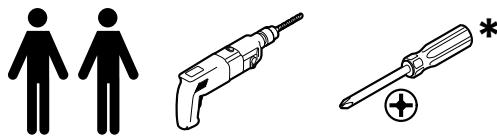
\* **VORSICHT:** Bei Verwendung eines Akkuschraubers (nicht empfohlen) möglichst niedrige Drehmomentstufe wählen!
